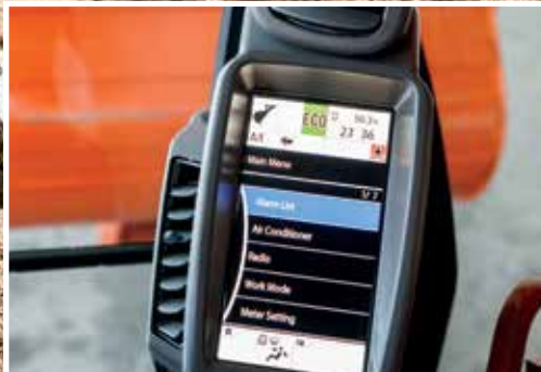
L'écran LCD affiche le statut et les paramètres de la machine.
